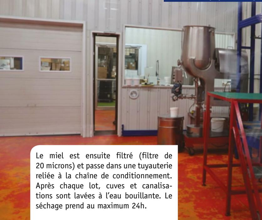
Le miel est ensuite filtré (filtre de 20 microns) et passe dans une tuyauterie reliée à la chaîne de conditionnement. Après chaque lot, cuves et canalisations sont lavées à l'eau bouillante. Le séchage prend au maximum 24h.
