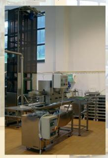
percule puis passe dans un second élément où une série d'yeux électroniques repèrent les zones encore operculées et enclenchent des griffes qui viennent déchirer les opercules restants. Les opercules tombent dans une presse très performante. Le cadre désoperculé est alors glissé dans un panier en inox qui
