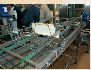
sera dirigé vers l'extracteur à axe horizontal d'une capacité de 12 x 9 cadres. Le temps et la vitesse d'extraction sont programmés. Avant et après l'extracteur, on trouve une colonne de stockage d'une capacité de 12 supports de cadres pour gagner de l'espace dans le local. La seule manipulation en fin de chaîne consiste à replacer les paniers avec
