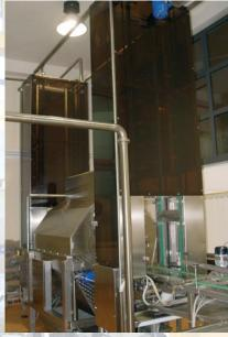
leurs cadres extraits dans les hausses et de reprendre celles-ci remplies pour le stockage ou pour les remettre sur les ruches. Après le passage dans un bac décanteur et 3 passages de filtres, le miel est pompé vers trois grands maturateurs de 7 t. Un tel volume permet d'assurer un bon écumage avant la mise en fûts. Chaque fût est pesé et étiqueté.
